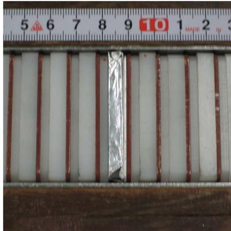
図 3.7 エルビウムサンプルセルの燃料体への実装
