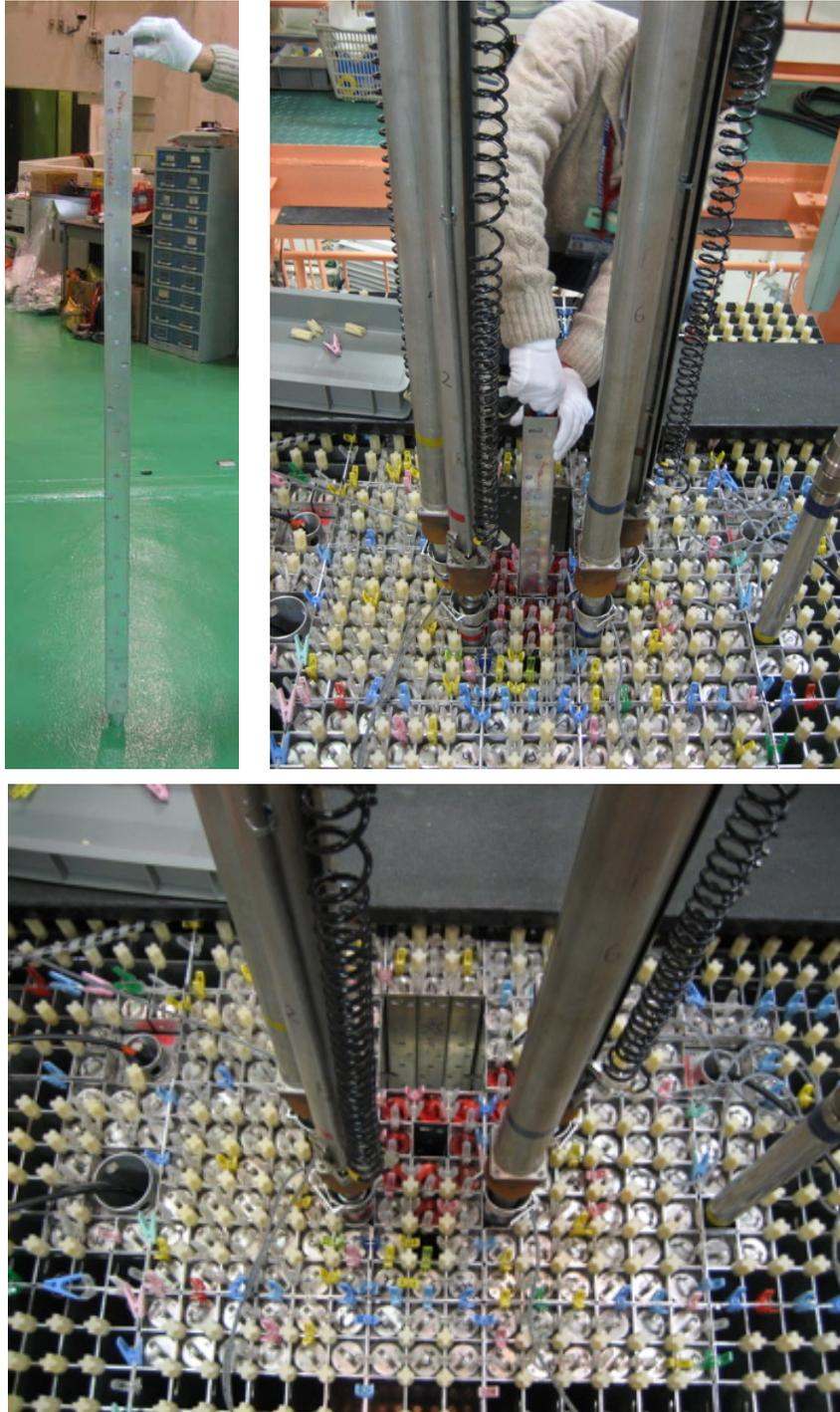
図 3.8 サンプル燃料体及び炉心への装荷
