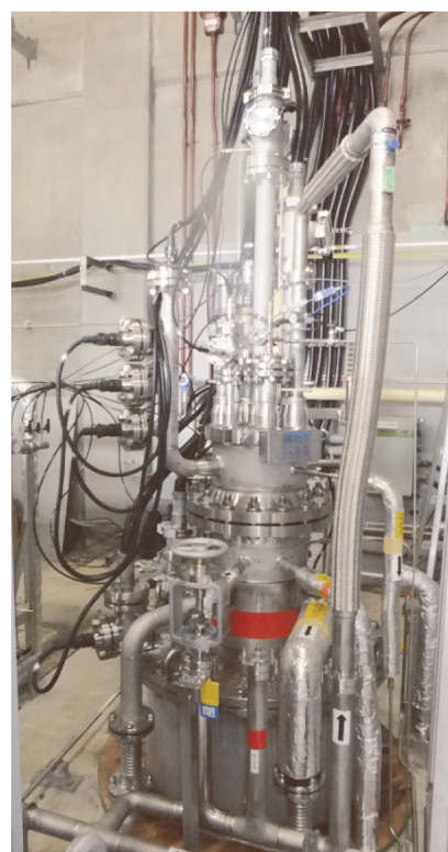
図 液体水素冷却超電導材料特性試験装置の写真
