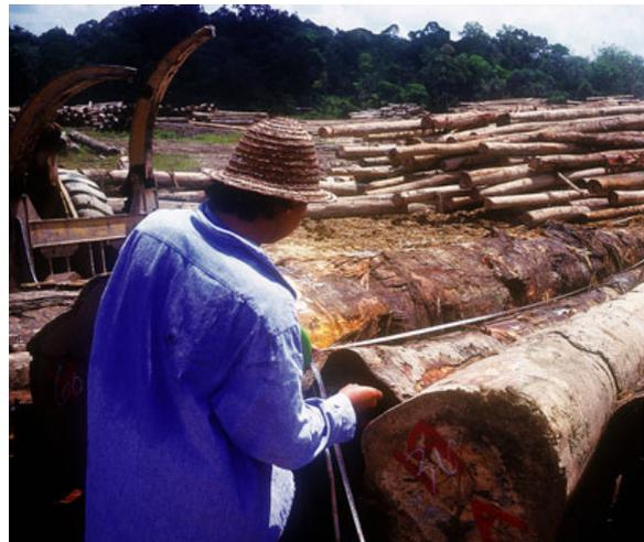
東マレーシアのサラワク州北部の貯木場。スケーラーと呼ばれる地元のダヤックやインドネシア人労働者によって丸太の測定が行われる(2000年9月3日石川撮影)
