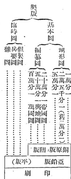
略以上の如くであるが、基本地形圖の一般的製版法としては、寫眞電氣銅版法に依るを本體とし、若干彫刻銅版法及び光蝕銅版法をも併用せられて居るが、又臨時的諸地圖の製版に當つては、寫眞亞鉛版法、直印畫亞鉛版法、轉寫又は直畫亞鉛版法等をも採用せられて居るのである。
