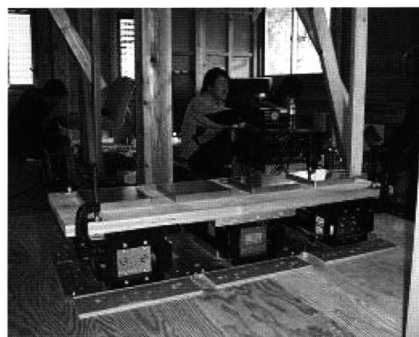
写真8 小型起震機によるエコ住宅の振動性能実験
