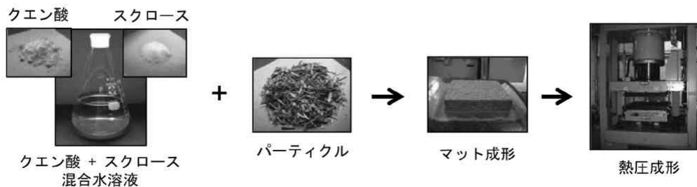
図6. パーティクルボードの製造方法
