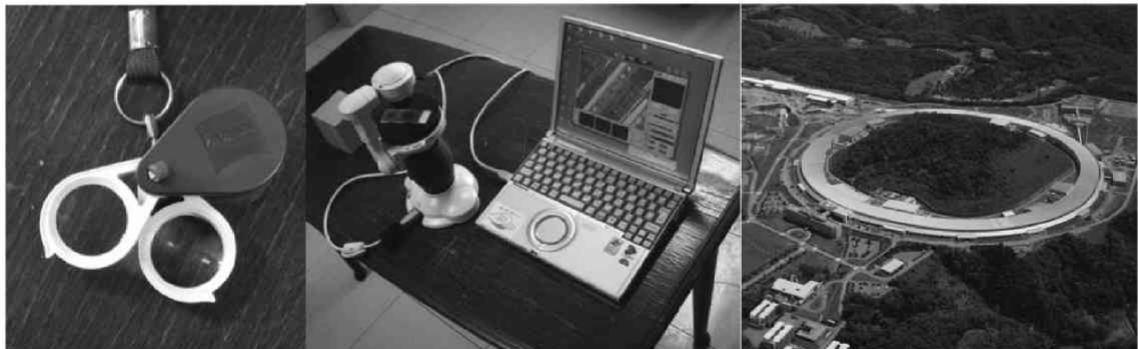
図4 木材を観察するいろいろな道具。(左) ルーペ。サンプルの大きさを問わず、非破壊で表面観察できる。しかし倍率は20倍程度に留まり、木材の解剖学的な特徴をすべてみる事ができない。(中) デジタル顕微鏡。持ち運びが可能で光学顕微鏡でみることのできる特徴が観察可能。フィールド調査に便利。ただし、プレパラート切片が必要であり、試料の破壊はさけられない。(上) 大型放射光施設 SPring-8。蓄積リング内を光のスピードに加速された電子から制動放射されたX線を利用して研究を行う施設。リング内にいくつもの実験室があり、その中に、CT専用の部屋がある。サンプルの大きさは制限があるものの（1ミリメートル以下）、1マイクロメートルを切る解像力がある。
