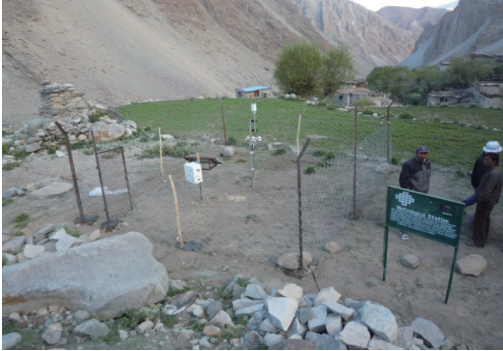
写真1 ドムカル上村のAWS設置状況。
