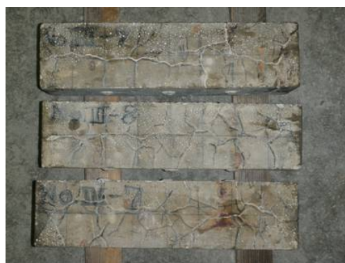
(c) 暴露開始から 4 年経過時のひび割れ状況 (S-I-20w (非反応性骨材種：S 種, 配合：No.I, 暴露環境：20℃-水中))
