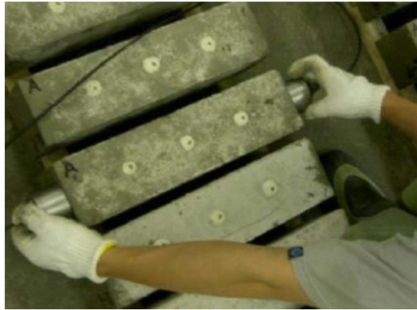
写真-2.2 超音波の伝播特性の計測状況
