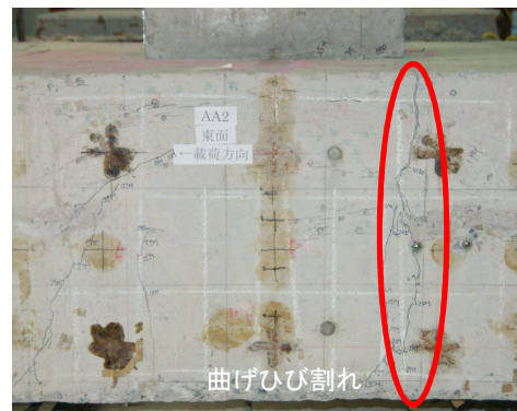
(c) 東側側面に発生した曲げひび割れ
