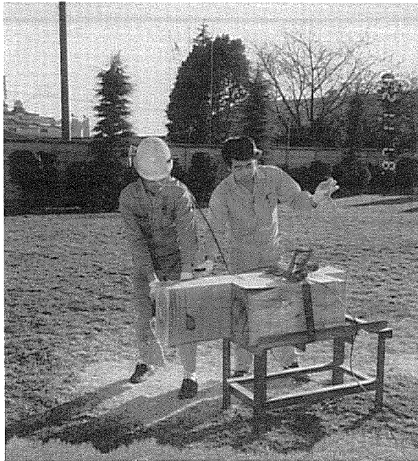
写真一4 CH25型の騒音測定風景
