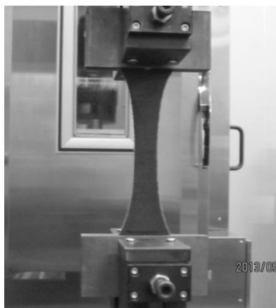
写真-3.3 一軸引張試験中
