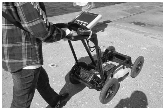
写真-6.4 地中レーダー(G.P.R.)による空洞探査
