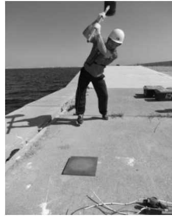
写真-6.1 カケヤによる起振時の様子
