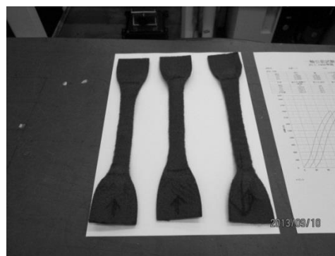
写真-3.4 一軸引張試験後の供試体
