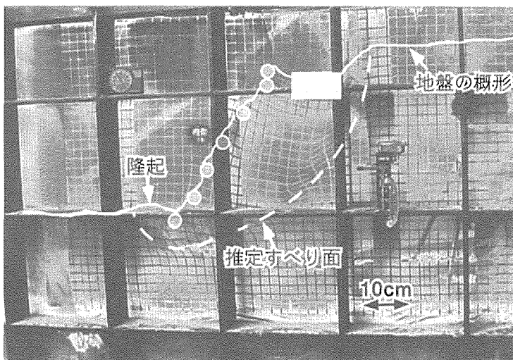
図-14 側面における変形状況(2)：補強斜面への載荷実験における載荷終了時
