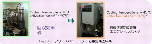
Fig. 2. ロータリーエバポレーター 有機溶媒回収系
