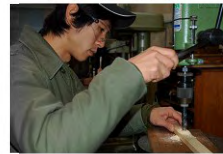
ボール盤作業
