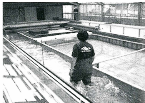
写真6-4 通路模型（幅1 m, 30m）
