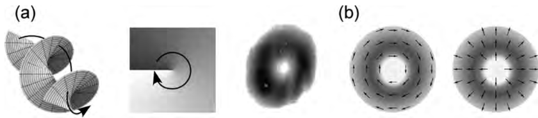
図 1: 本稿で扱うトポロジカル光波の概要: (a) 光渦 ( \ell = 1 のラゲールガウス光) の波面 (左)、断面位相分布 (中央) および強度分布 (右)、(b) 径偏光渦 (左) と方位偏光渦 (右)
