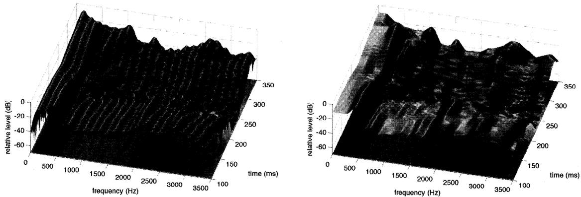
図 9: 実際の音声の短時間 Fourier 変換によるスペクトログラムの 3D 表示 (左図) と STRAIGHT スペクトログラムの 3D 表示 (右図)。
