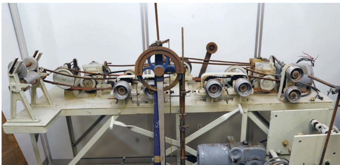
公益社団法人日本化学会の「化学遺産」に認定されたビニロン紡糸実験装置 —関連記事 本文3668ページ—
