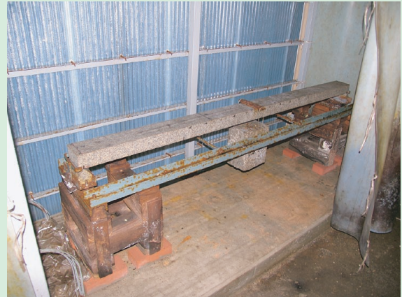
花崗岩流動室内実験のための花崗岩石柱。自重だけでの変形を観るためのもの(上)と、中央部に荷重を掛けているもの(下)がある。
