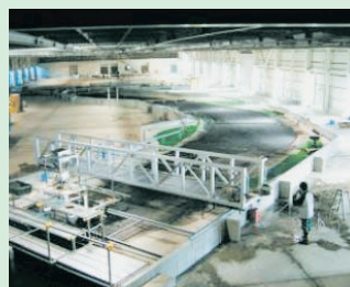
木津川流路模型による河床変動実験
