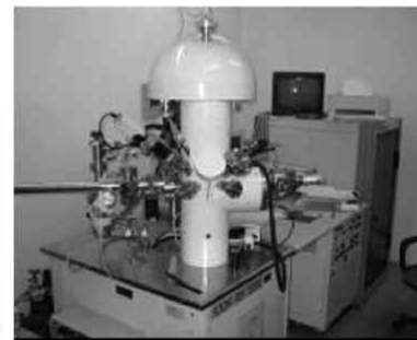
写真 4 : 縦型油圧試験機 写真 5 : 鋼製反力フレーム 写真 6 : X 線光電子分析装置
