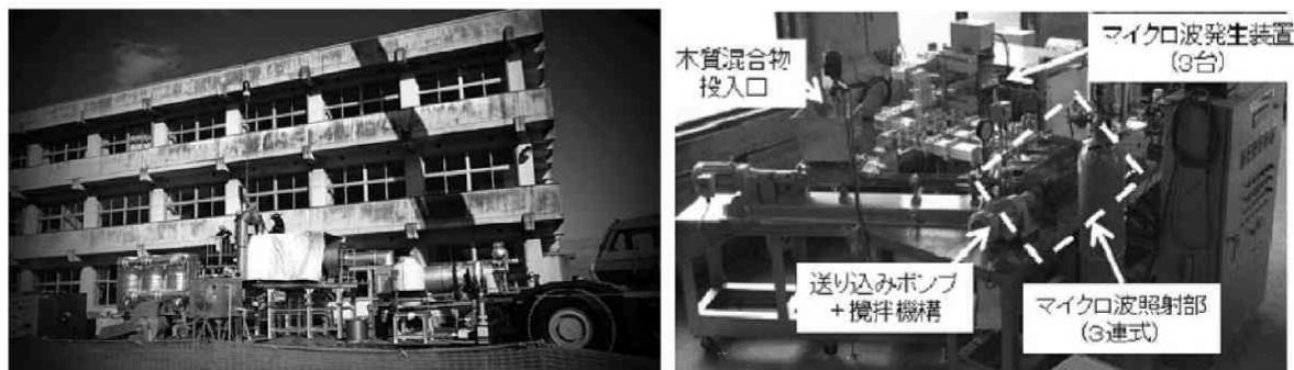
図 5：宮城県名取市に設置されたマイクロ波による非飛散性アスベスト無害化処理装置と、実験室に設置されたバイオエタノール生成用マイクロ波前処理装置
