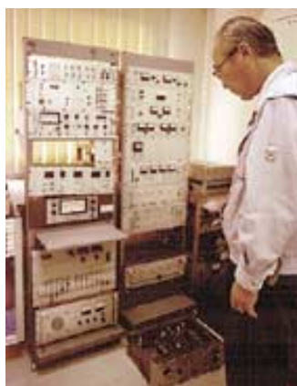
家原氏が開発したNMR（核磁気共鳴）測定装置
