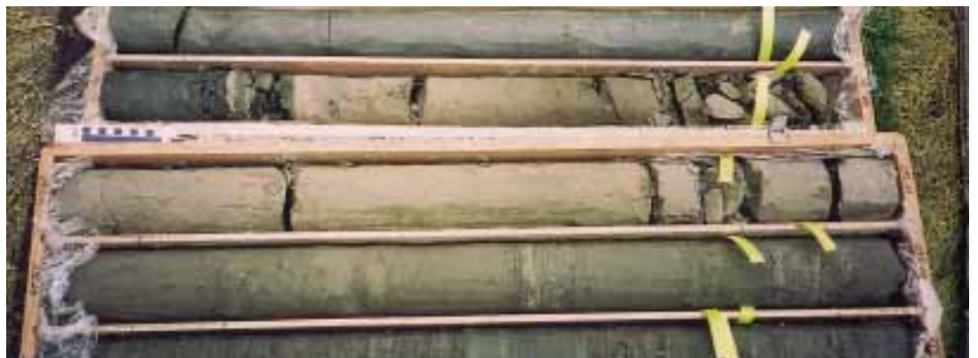
琵琶湖での掘削調査(1995年)と第四紀堆積物クレーン付き台船で調査地点に向かう。錘りを付けたパイプにより、湖底の堆積物を採取できる。1本のパイプの長さ3mを数本つなぐ。琵琶湖では10mで6000年間程度(縄文時代前期以降)の歴史を保存している。地層の時間の指標となるのが粘土層のなかにあらわれる火山灰(色の薄い層)である。九州の火山灰は琵琶湖にトラップされている。右下は京都盆地で採取されたコアの例。
