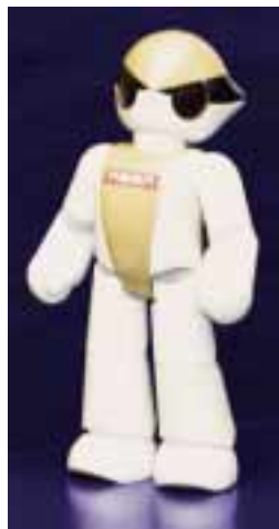
高橋さんがつくった、無線操縦の2足歩行ロボット「ネオン」。足裏に電磁石がついていて、転倒しないで鉄板の上を歩く。この電磁吸着から新たな特許が生まれた。高さ40センチ、1・4キロ、全体で22個、各関節に1個ずつモーターが入っている
