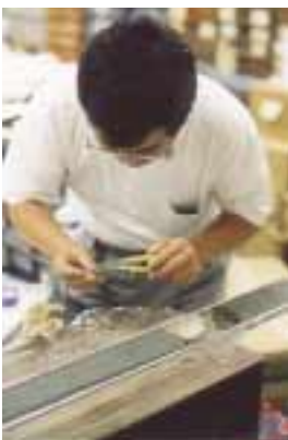
琵琶湖での掘削調査(1995年)と第四紀堆積物クレーン付き台船で調査地点に向かう。錘りを付けたパイプにより、湖底の堆積物を採取できる。1本のパイプの長さ3mを数本つなぐ。琵琶湖では10mで6000年間程度(縄文時代前期以降)の歴史を保存している。地層の時間の指標となるのが粘土層のなかにあらわれる火山灰(色の薄い層)である。九州の火山灰は琵琶湖にトラップされている。右下は京都盆地で採取されたコアの例。
