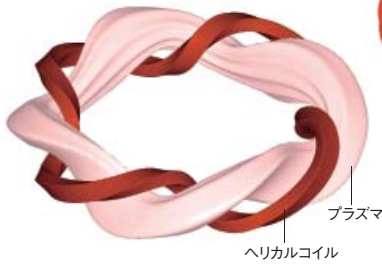
ヘリカル軸ヘリオトロン磁場。 ヘリオトロンJ (2000年)の装置。
