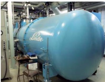
↑ヘリウム液化機。毎時300リットルの液体ヘリウムをつくる能力があり国内最大。
