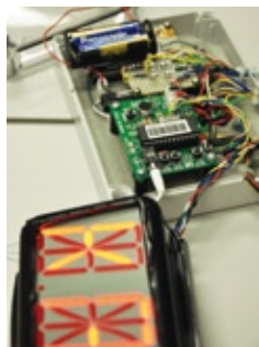
センサが読み取った情報をマイコンに送り、文字の種類を判定して音声を再生
