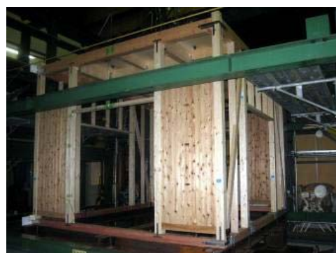
壁柱方式耐震補強工法 試験体の全体写真
