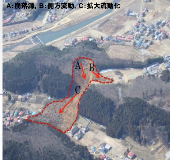
白河市葉ノ木平の地すべり性崩壊 (国交省撮影の斜め写真に加筆, 3月14日)
