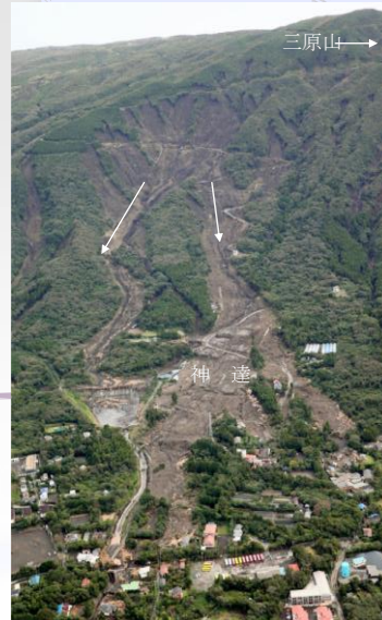
伊豆大島町大金沢上流の表層崩壊と被災した神達地区の斜め写真(国交省中部地方整備局, 2013年10月16日撮影に加筆)
