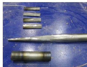
写真 1 膨張部分の試作 (左:部品, 中:初期, 右:膨張時)
