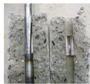
写真 3 載荷後の円柱供試体の様子 (左:ひび割れ状況, 右:内部の状況)
