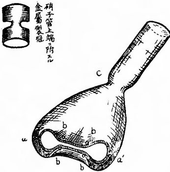
第二圖 器具ノ圖示 全長十糎 膨隆部 長經 三、四糎 同 短經 二、三糎
