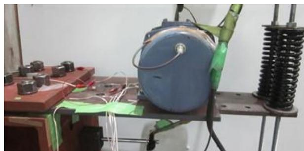
図-4.12 板曲げ疲労試験機
