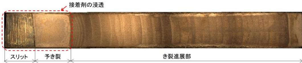
(b) 試験体 N+CFRP
