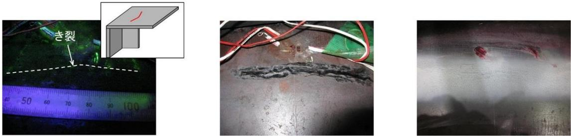
(a) ICR 処理前の MT の結果 (b) ICR 処理後のき裂の閉口状況 (c) ICR 処理後の PT の結果
