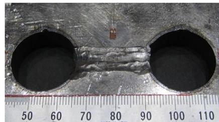
図-4.36 ICR 処理後の試験体の表面状態
