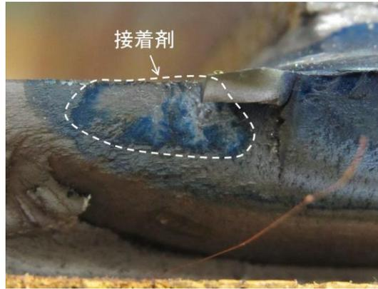
図-5.35 き裂部に浸透した接着剤
