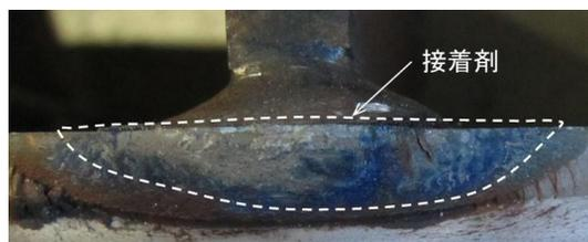
図-5.39 き裂部に浸透した接着剤
