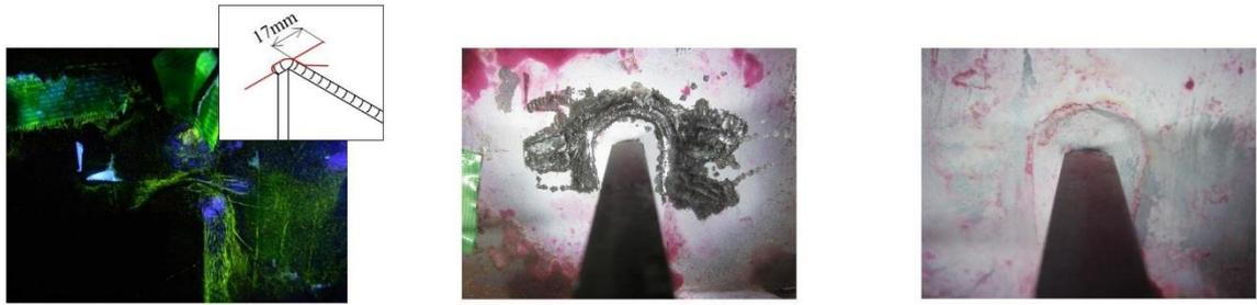
(a) ICR 処理前の MT の結果 (b) ICR 処理後のき裂の閉口状況 (c) ICR 処理後の PT の結果
