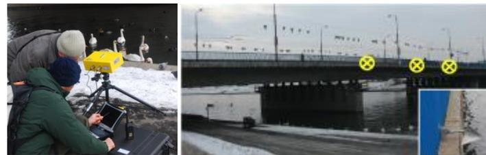
GBSAR(イタリア製) 観測対象点にレーダ反射器を設置
