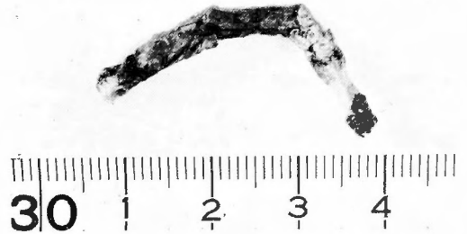
第13図 Eastman 910 Adhesive を単独で coating した例。樹脂膜に輝裂がみられる
