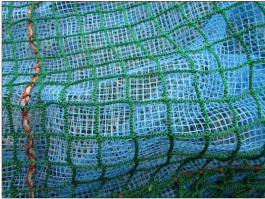
図 7. マクロベントス用ドレッジの袋部。外網（目合い 25 mm）と内網（目合い 4 mm）の二重構造。
