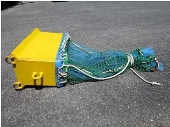
図 9. マクロベントス用ドレッジ使用時の状態。袋部の端をロープで縛って、袋状にしている。
