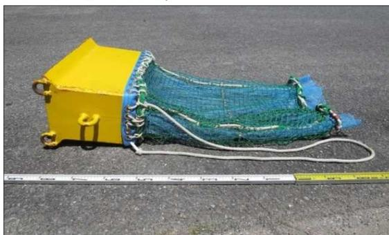
図 6. 新たに製作したドレッジ装置（マクロベントス用ドレッジ）の全形。
