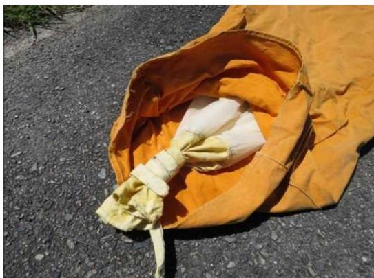
図 5. メイオベントス用ドレッジの袋部。外袋（キャンバス生地）と内袋（目合い 0.2 mm のプランクトンネット生地）の二重構造。
