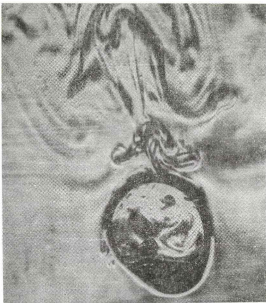
トルエン滴から水（連続相）へアセトンが移動するとき、アセトンの移動によって生成する界面
