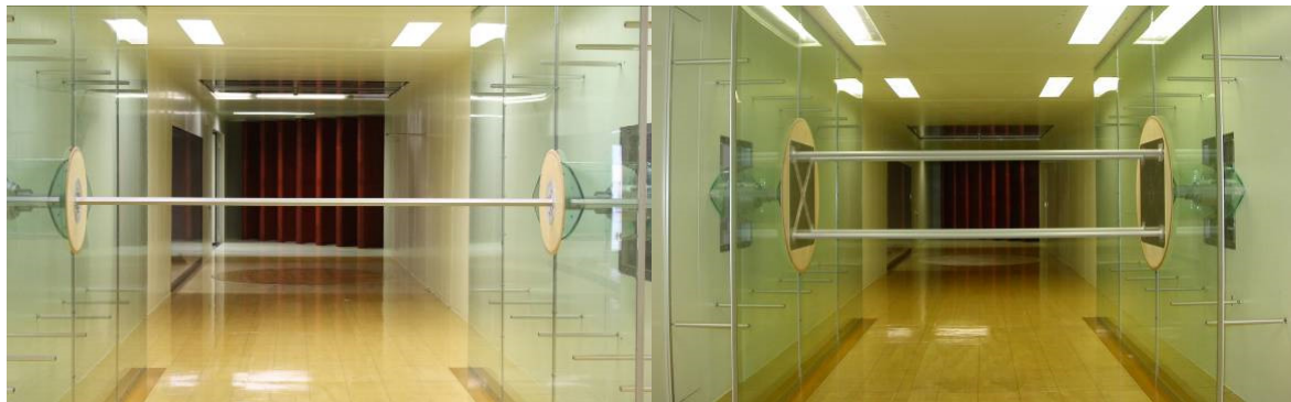
(a) 単導体電線，天秤測定実験 (b) 4導体電線，圧力測定実験 図 3.1.4 風洞内での模型設置状況
