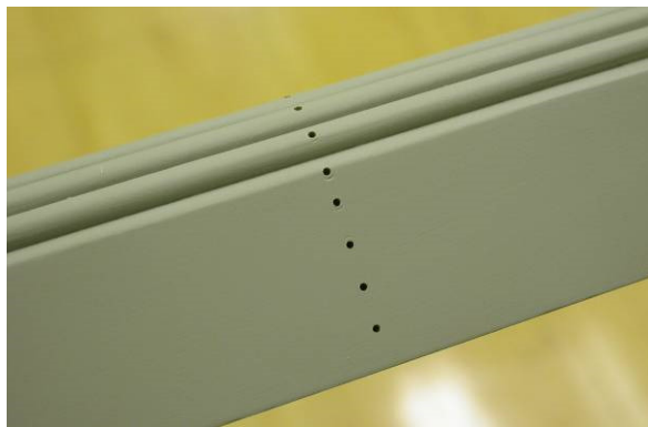
図 3.1.5 圧力測定孔の状況（三角中）
