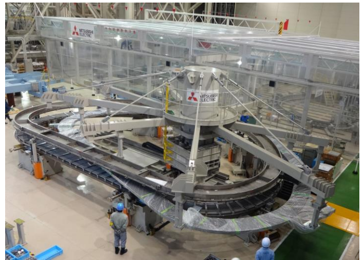
図2 ITER用TFコイルの製造(三菱重工/三菱電機提供)
