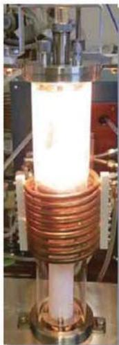
写真1:放射化金属の加熱模擬実験の様子
