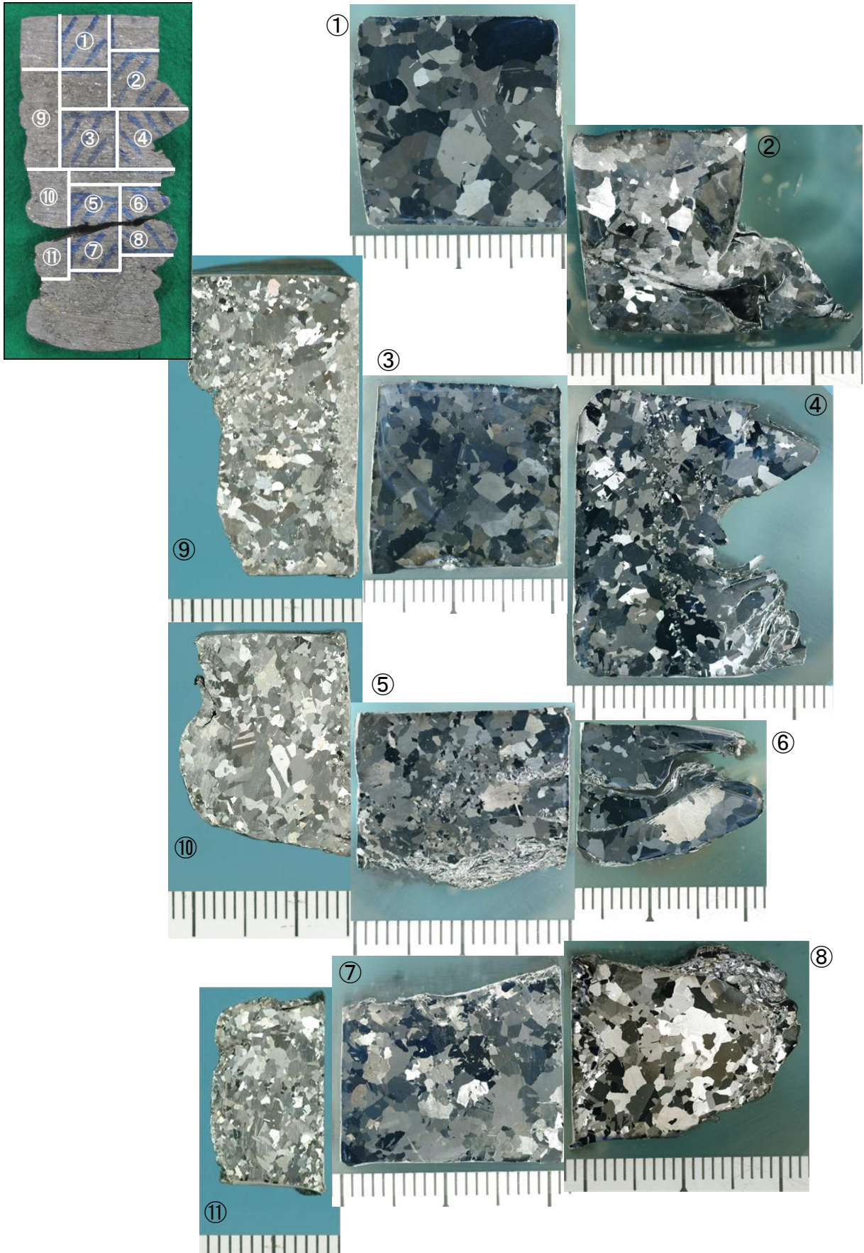
写真-4.2.3 リファレンス支承 L1 試験後の結晶観察結果
