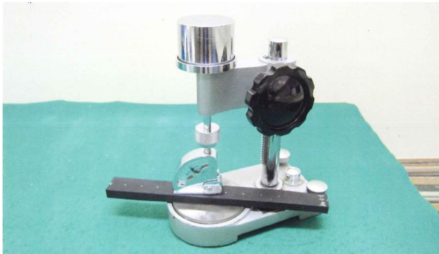
写真-2.4.3 硬さ試験状況
