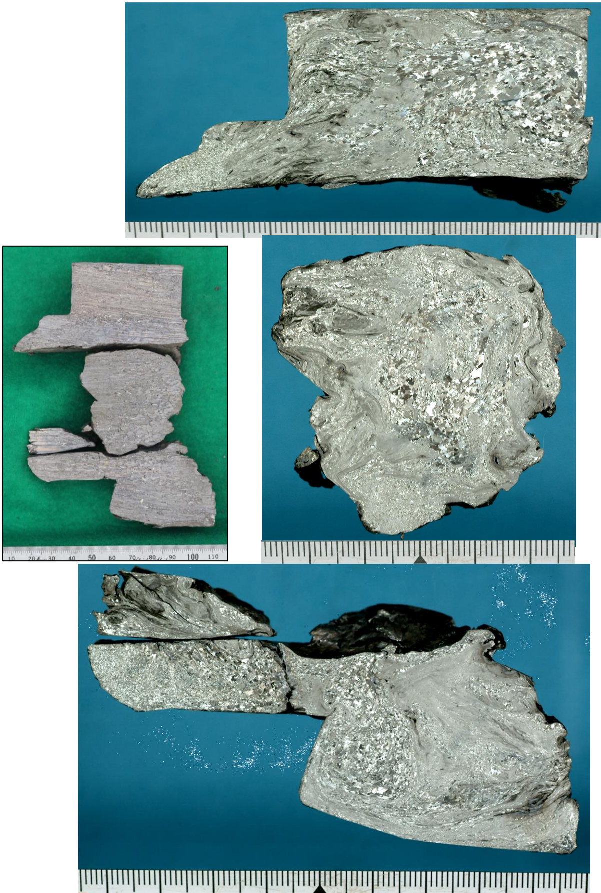
写真-4.2.4 劣化支承 L2 試験後の結晶観察結果
