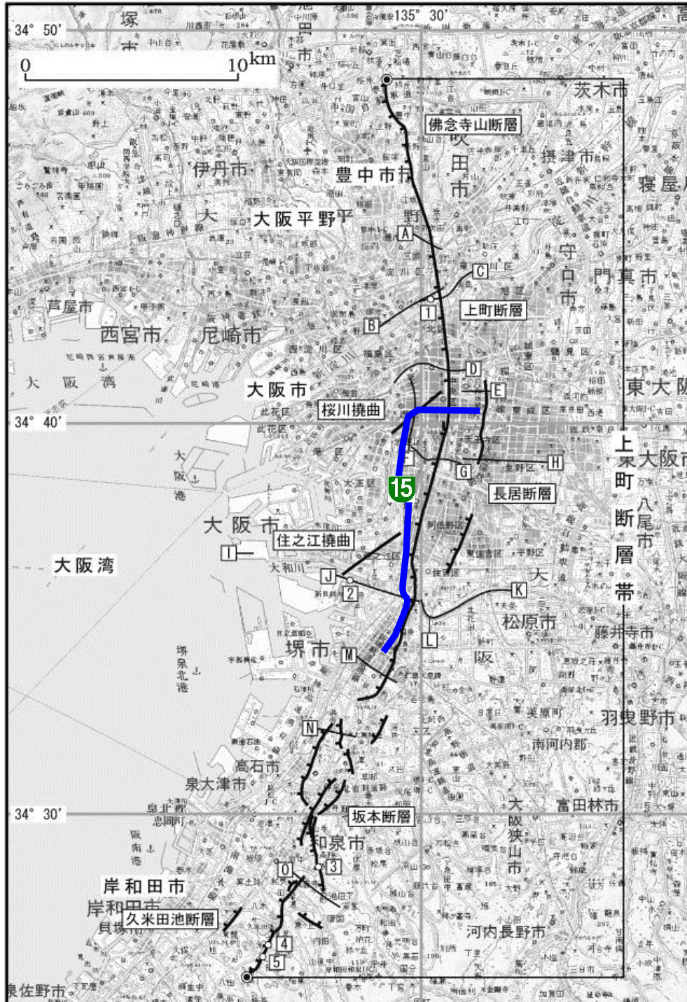
図-3.2.14 上町断層帯と阪神高速道路 15 号堺線との位置関係
