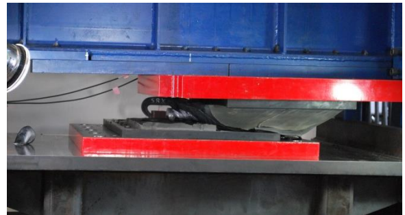
(b) 完全破断時
