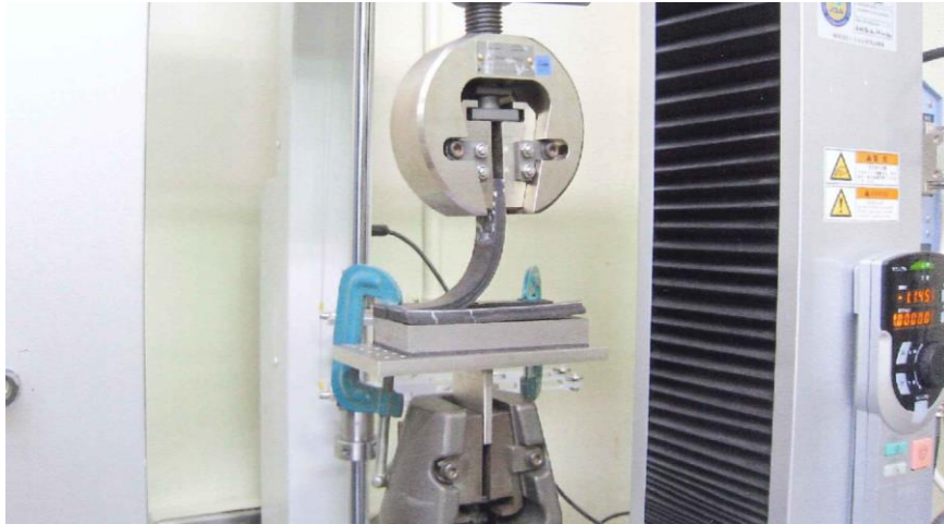
写真-2.4.4 接着剤はく離試験状況
