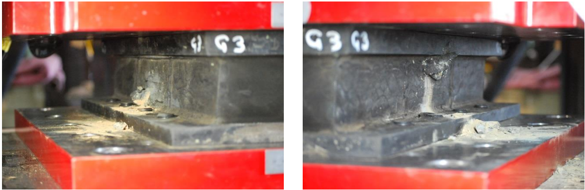
写真-2.3.3 劣化支承側面状況(載荷開始前)
