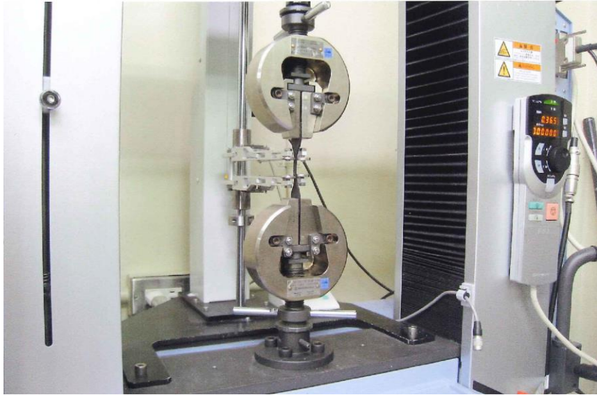
写真-2.4.1 引張試験状況
