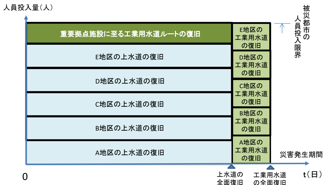
図-5.34 災害時における上水道および工業用水道の復旧にかかる人的資源投入配分の基本的なシナリオー A～E地区を有する被災都市のモデルケースー
