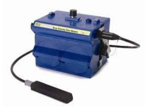
Figure 5-1 A flow sensor 2150 AV – ISCO connects with recorder
