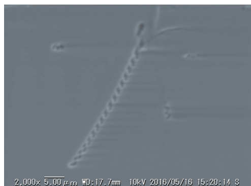
▲シリコンウエーハ表面に形成された螺旋状ナノポアの電子顕微鏡写真 SEM image of a helical nanopores formed on the surface of a silicon wafer
