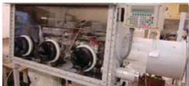
写真2:ウランを使用するためのグローブボックス
