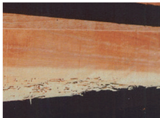
写真2：シバンムシ類による建築部材の被害（左）とヒラタキクイムシ類とナガシクイ類によるパレット材の複合被害（右）。後者では辺材のみが被害を受けているのがよくわかる。
