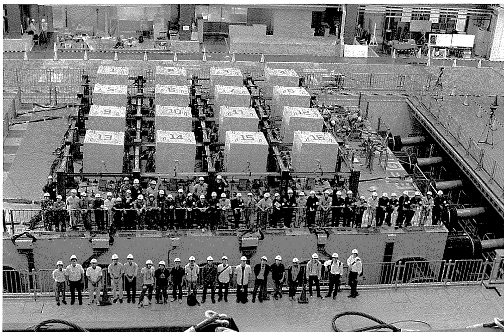
16体縮小RC橋脚一斉加振実験
