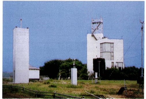
写真-3.10 自然風中に置かれた建物模型による非定常風圧力の研究
