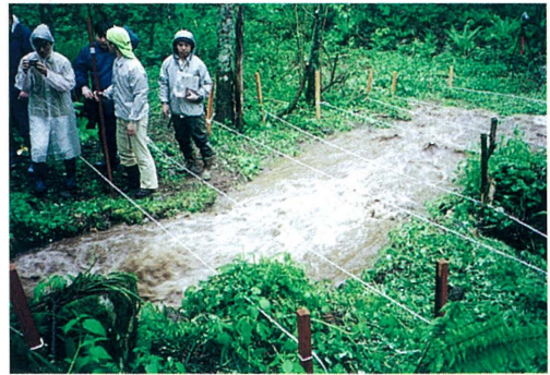
写真-3.12 ヒル谷試験ダムの排出土砂による実験
