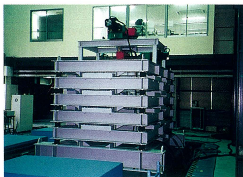
写真-3.2 振動台による制震実験用建物モデル
