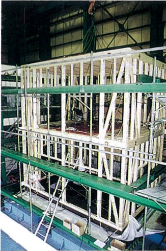
写真-3.3 2階建木造住宅の実大振動試験
