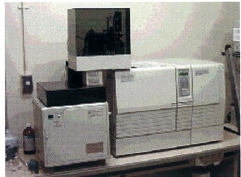
写真-3.5 地盤環境影響物質の微量分析装置；(左)高周波プラズマ発光分析装置による分析。ネブライザ、チェンバ1)より霧化した試料をプラズマ2)内へ導入する。高周波融合プラズマによって試料に電気/熱エネルギーを与えることにより発光させ、放射された光を3)を通して内部の分光器により各元素固有のスペクトル線に分け、スペクトル線の有無と強度から試料中の元素の定性/定量分析を行う。無機汚染物質に適用。(右)ガスクロマトグラフ質量分析計。有機系汚染物質の定性/定量分析
