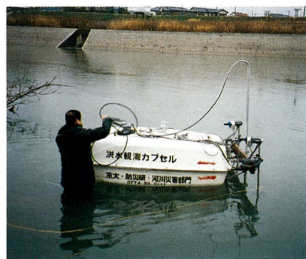
写真—3.8 洪水観測カプセルの宇治川における試用状況
