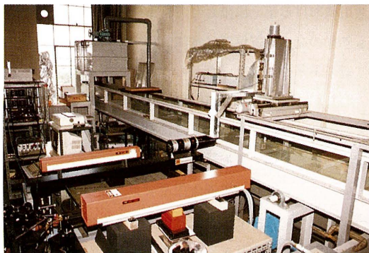
写真—3.6 レーザ流速計による乱流計測
