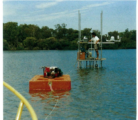
写真—3.14 オーストラリア, North Lake における水温計格子を用いた成層破壊過程の観測
