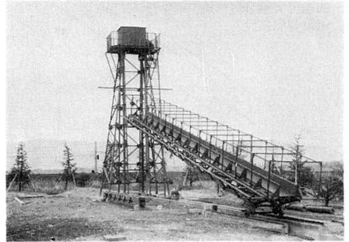
写真-2.10 斜面流出実験装置
